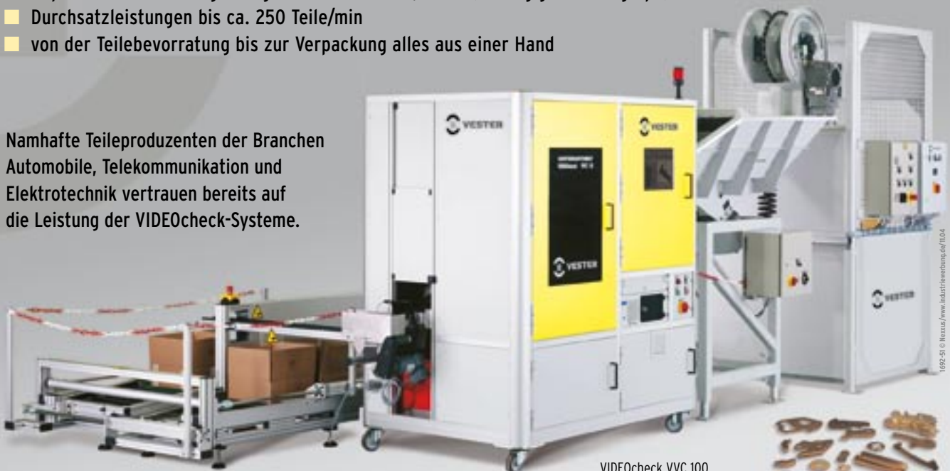
VIDEObot VVC 100 mit Hebe-Kippgerät, großer Bunkerwanne und Teilechargierer für die automatische Befüllung von Kartons
